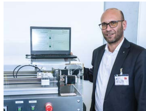
“Met drie-assige versnellings-sensoren en machine learning ontdekken we waar defecten op de spindel zitten”, aldus Claudio Geisert bij het Berlijnse Fraunhofer IPK. (Foto: LDS)
