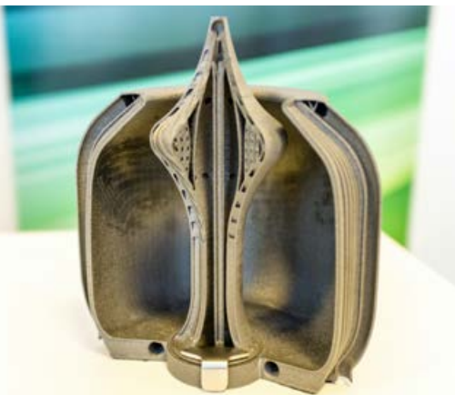
Deze 3D-geprinte Aerospike-raketmotor van Fraunhofer IWS ontwikkelt zo’n 50.000 Newton. (Foto: LDS)
